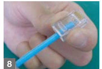
8 ガイドをプラグ本体に挿入します(ガイドが奥まで挿入しているか確認してください)
