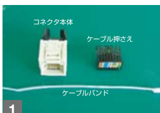
1 三和電気工業(株)製E-CAT5-SMJU(専用工具は不要です)
